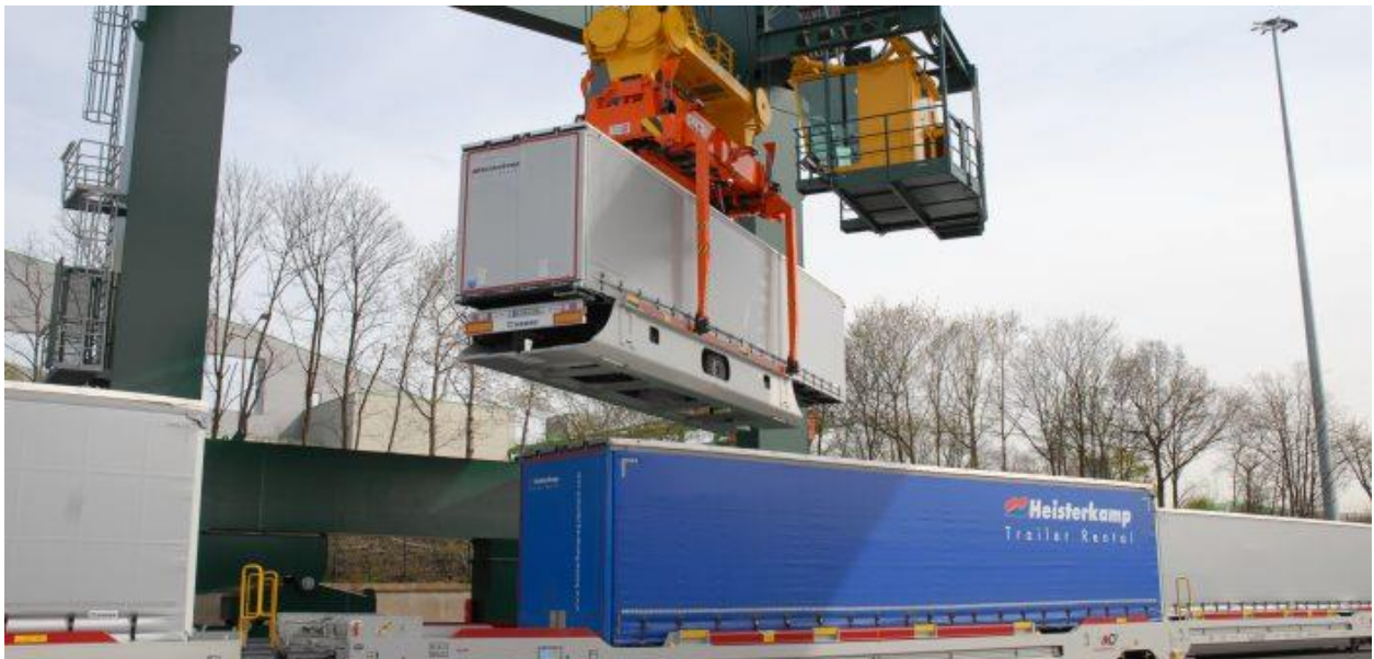
Foto 5.2.3.4. CargoBeamer alusel haagise kraanaga 1435 mm madala põhjaga spetsiaalplatvormile laadimine
