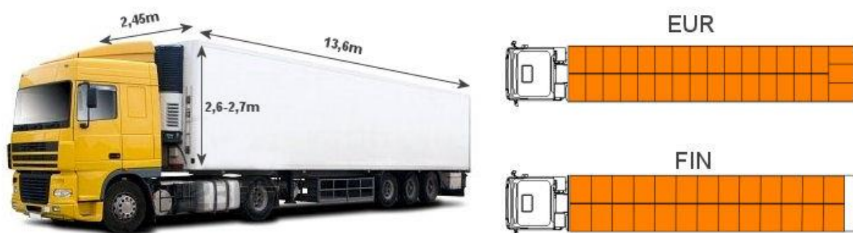
Joonis 5.2.6.2. Aluste paigutus veoauto kaubaruumis 116
